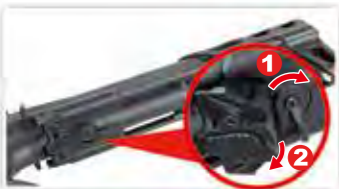
將伸縮托拆卸鈕順時旋轉後，掀開定位卡榫即可取下後托。
